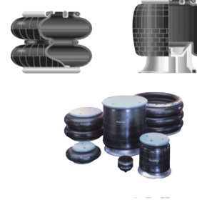
HAVALI SÜSPANSİYON SİSTEMLERİ (KÖRÜK)
